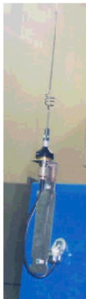
全方位天线通过 SRM6200E 以太网无线电调制解调器接收和发送数据
